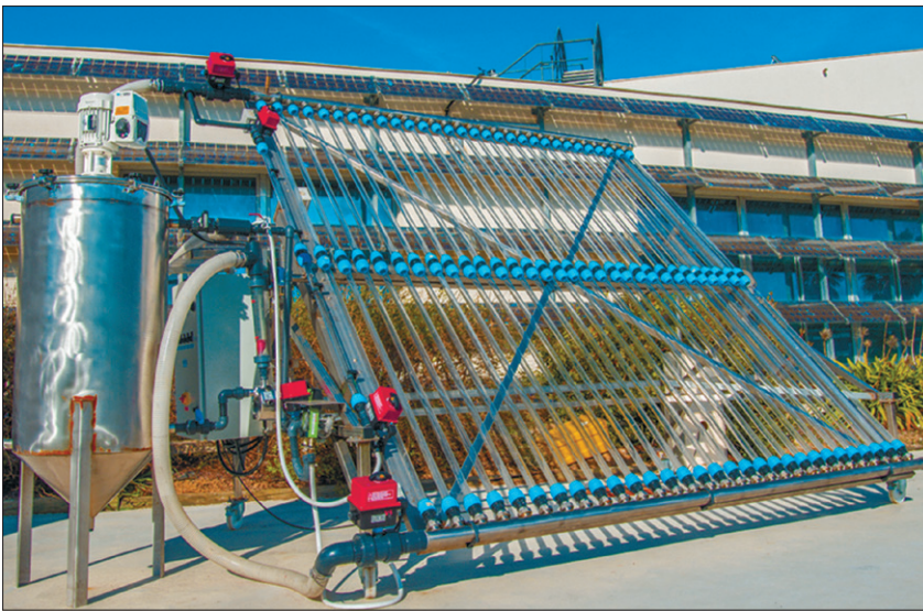
◀ Photo-réacteur solaire tubulaire de deux mètres carrés, couplé à une cuve de stockage de 300 litres, développé par le laboratoire PROMES. Promes, CNRS, fourni par l'auteur.
